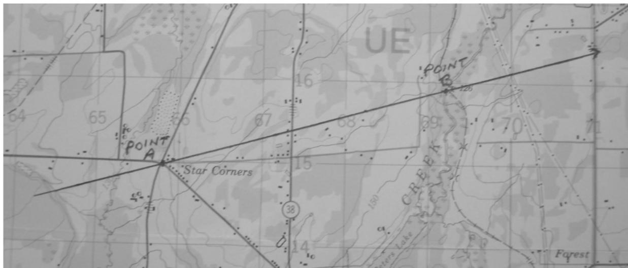
Figure 2 1<sup>re</sup> étape à suivre pour mesurer un azimut de quadrillage à l'aide d'un rapporteur
